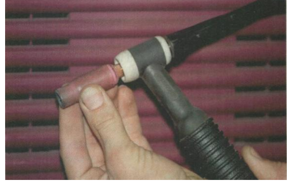
हावाले चिस्याउने टर्च फिट गरिएको वेल्डिङ सेट (GTA welding setup with a air-cooled torch)
